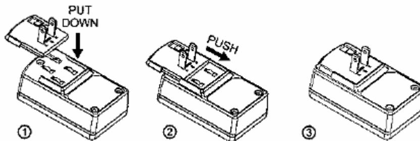
Kontaktieren Sie den Netzadapter-Stecker auf der Unterseite des Ladegerätes. Stellen Sie sicher, dass der Netzadapter-Stecker vollständig im Ladegerät eingeschoben (eingerastet) ist.
