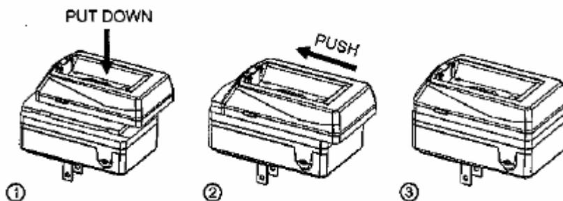
Befestigen Sie die Ladeschale an der Frontseite des Ladegeräts, indem Sie die Ladeschale von oben nach unten schieben, wenn die Ladeschale richtig eingerastet ist hören sie ein „Klick“.
