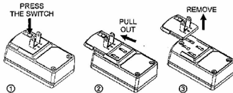
Zum Auslösen des Netzadapter-Steckers, drücken Sie den Schalter auf der Adapterplatte und ziehen Sie den Stecker vollständig aus dem Ladegerät
