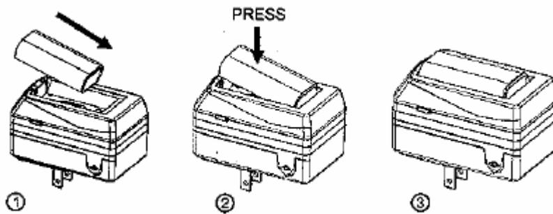
Schieben Sie den Lithium-Akku in die Ladeschale und drücken Sie ihn herunter, damit der Kontakt für den Ladevorgang hergestellt ist. Um den Ladevorgang zu starten, stecken Sie das Ladegerät in die Steckdose.
